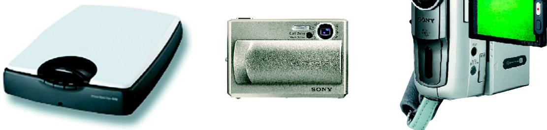
圖7.5 影像掃描器(左)、數碼相機(中)及數碼視像攝錄機(右)均可以擷取真實影像並下載到電腦。
